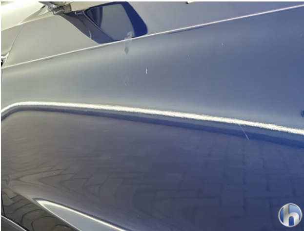
1. oneffenheden lakwerk Gebruikssporen - Aanvaardbaar
