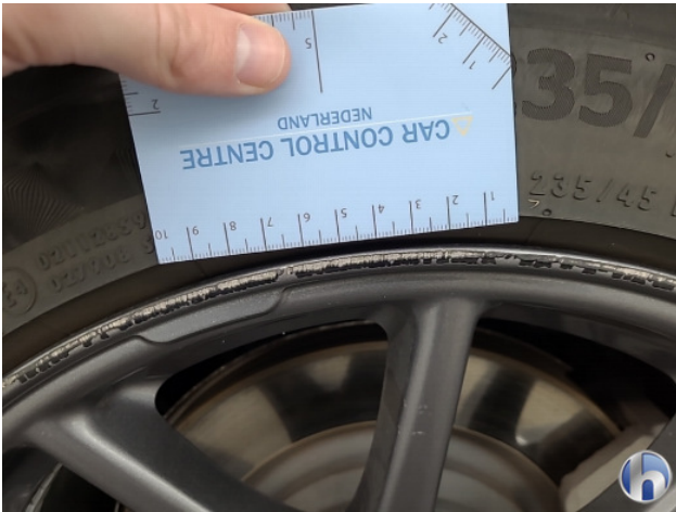
4. velgen Beschadigd - Herstellen
