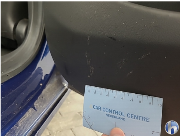
5. deurbekleding la/ra Beschadigd - Vernieuwen
