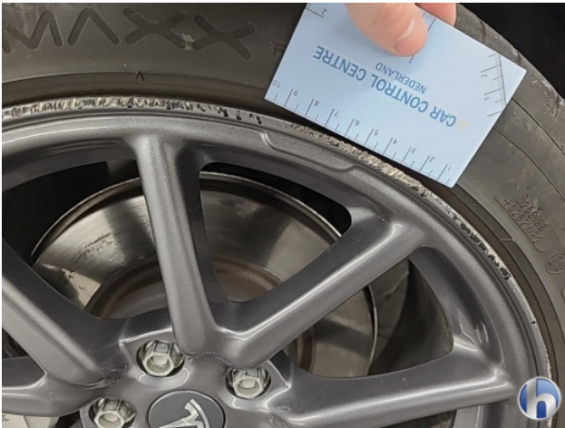
4. velgen Beschadigd - Herstellen
