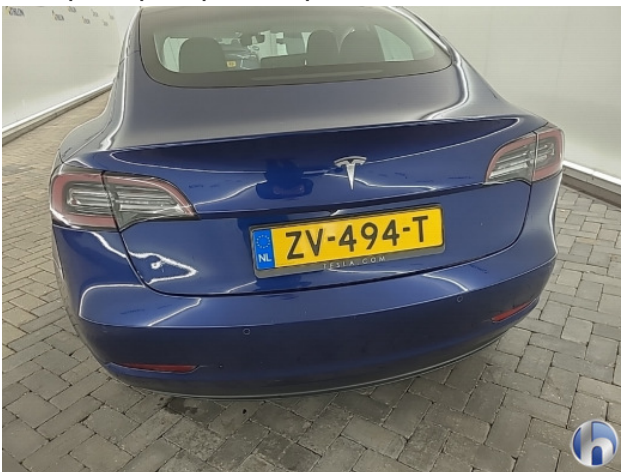
3. Achterbumper Schaafplek - Spot Repair/Deelreparatie
