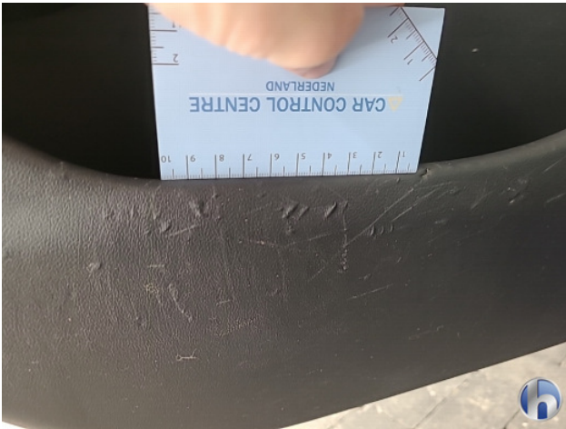
5. deurbekleding la/ra Beschadigd - Vernieuwen
