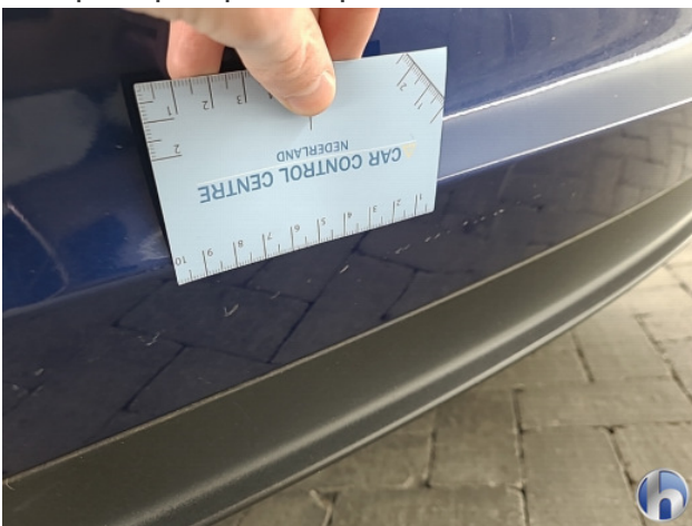
3. Achterbumper Schaafplek - Spot Repair/Deelreparatie
