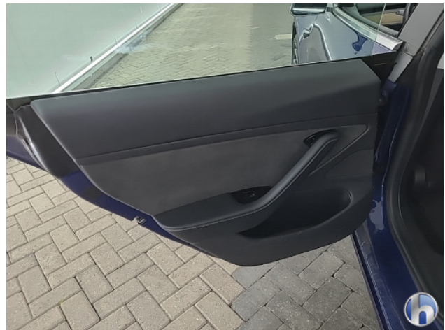
5. deurbekleding la/ra Beschadigd - Vernieuwen
