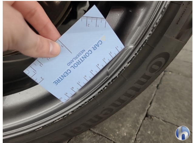
4. velgen Beschadigd - Herstellen
