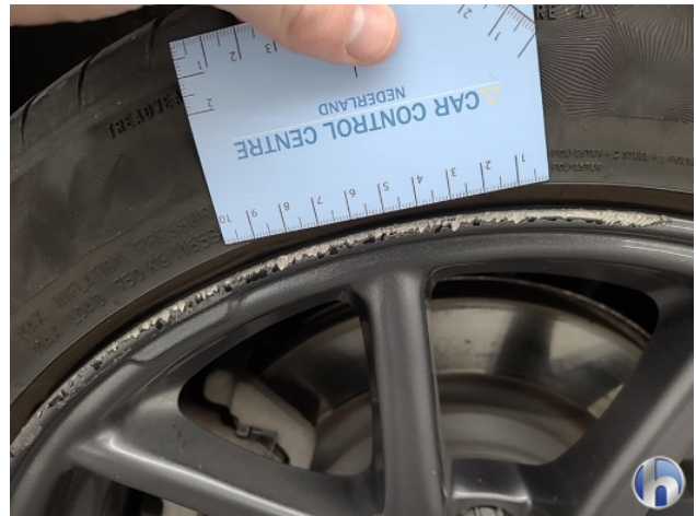
4. velgen Beschadigd - Herstellen
