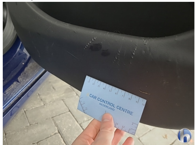
5. deurbekleding la/ra Beschadigd - Vernieuwen
