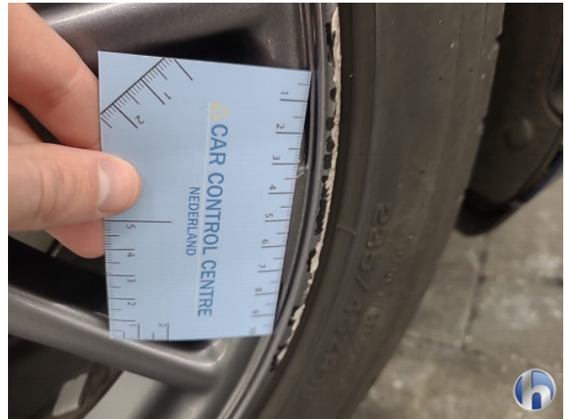
4. velgen Beschadigd - Herstellen
