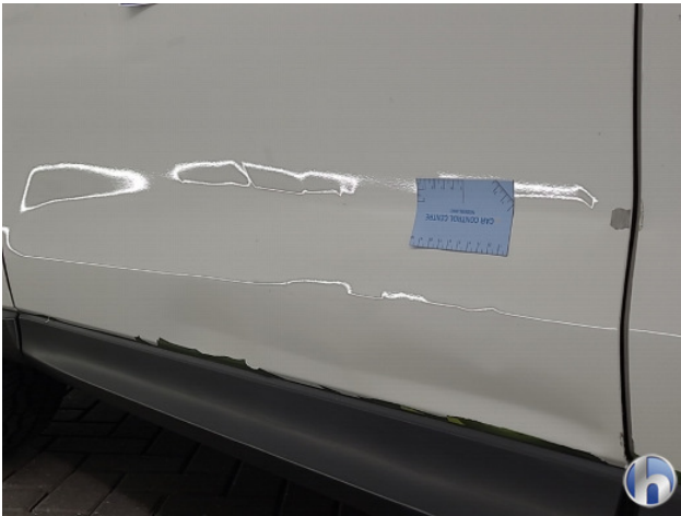
3. Portier voor - links Deuk/deuken - Herstellen
