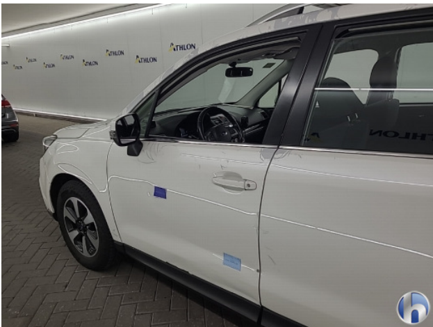
3. Portier voor - links Deuk/deuken - Herstellen
