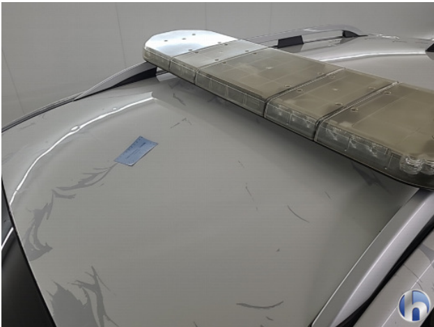
1. Dak Hagelschade - Herstellen zonder spuiten
