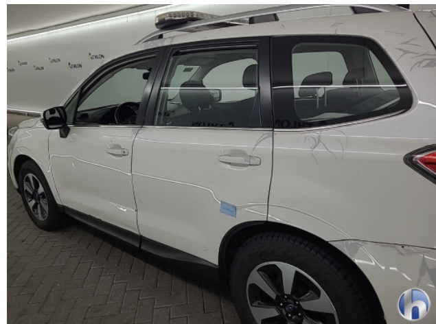
4. Portier achter - links Deuk/deuken - Herstellen
