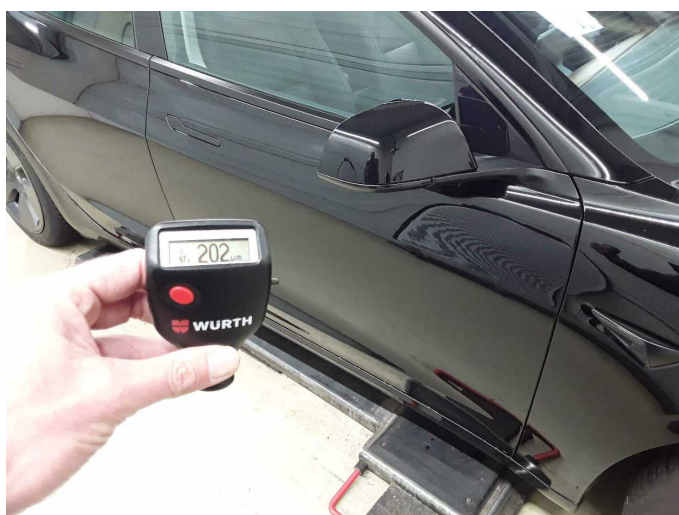
Door - front right side: 202 µm
