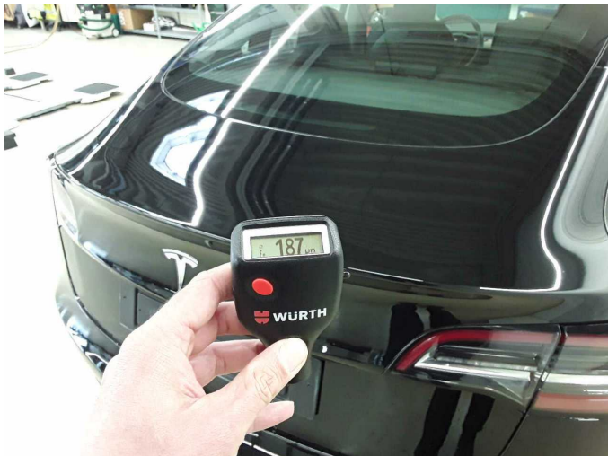
Boot lid / rear door: 187 µm
