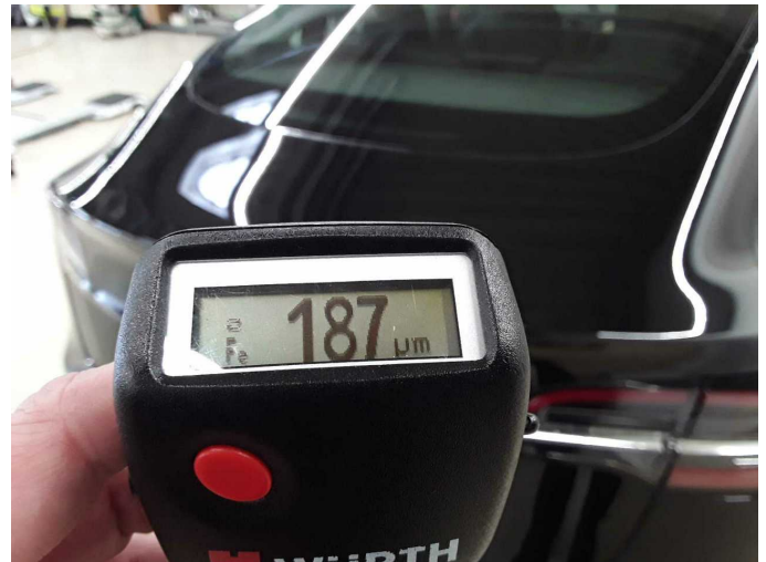
Boot lid / rear door: 187 µm
