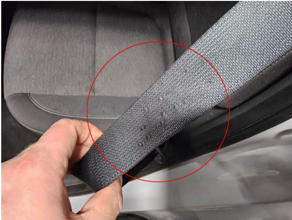
Bild 9 : Sicherheitsgurt hinten links beschädigt
