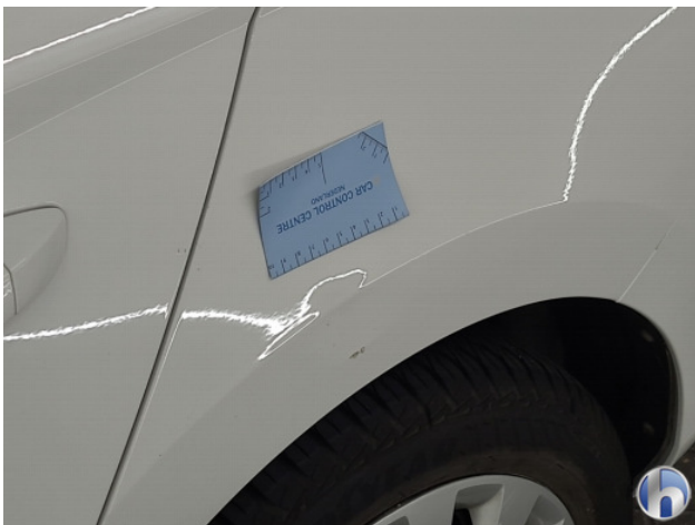
1. Zijwand - achter - Links Deuk/deuken - Herstellen
