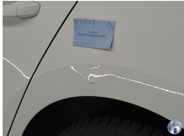
1. Zijwand - achter - Links Deuk/deuken - Herstellen
