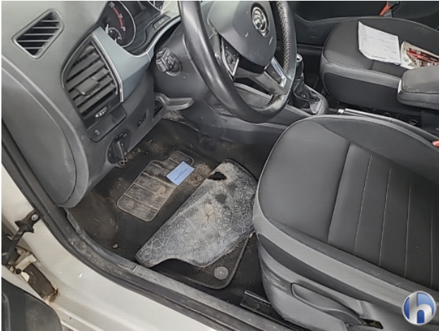
2. vloerbedekking Beschadigd - Vernieuwen
