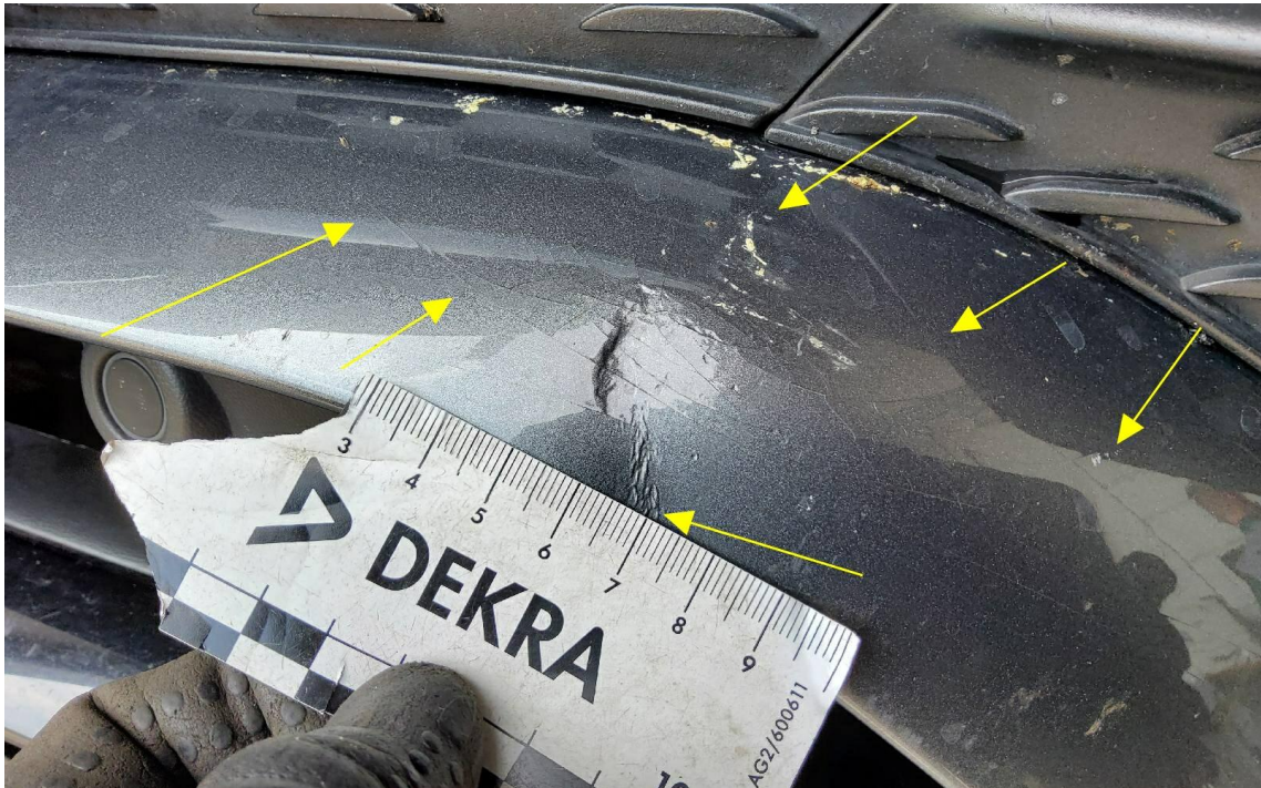
Bild 9 : Stoßfänger vorne, deformiert
