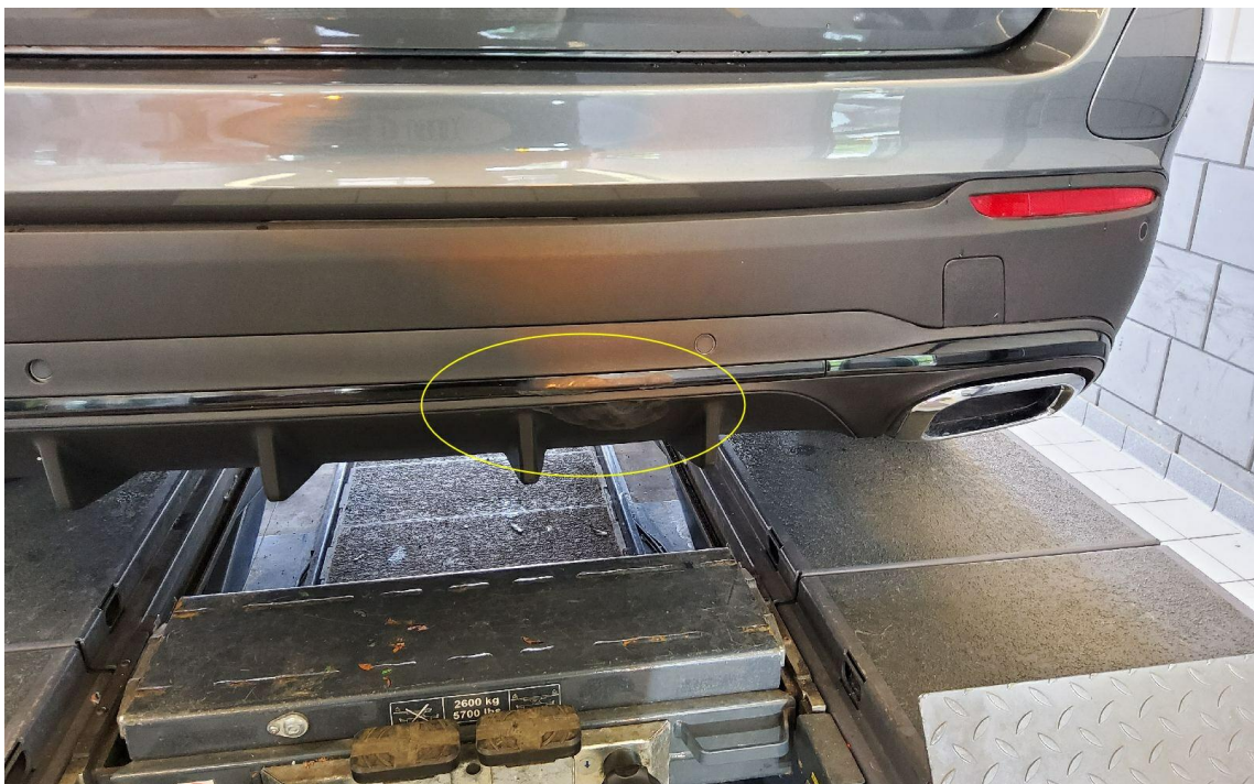
Bild 10 : Stoßfänger hinten, Blende unten und Zierleiste mitte, verschrammt / deformiert
