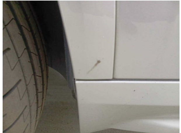
Beschädigung #3: Kotflügel links: Radlauf - Kratzer - Smart Repair
