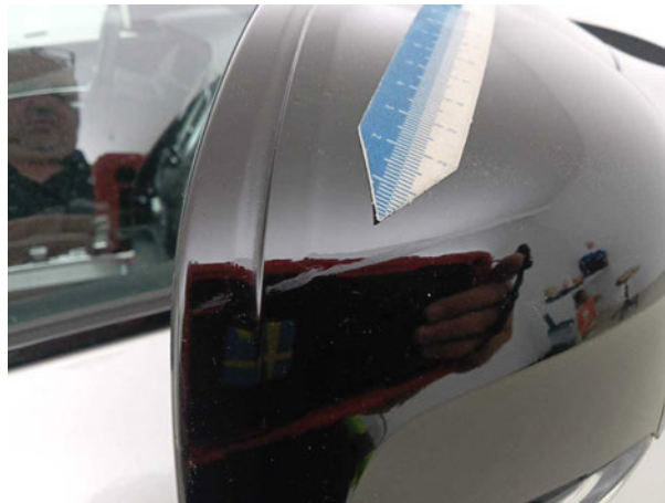
Beschädigung #1: Außenspiegel rechts: Abdeckkappe - Kratzer - Smart Repair
