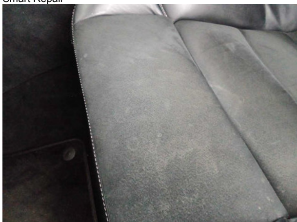
Beschädigung #2: Sitz vorn: Sitzpolster links - Abrieb - aufbereiten
