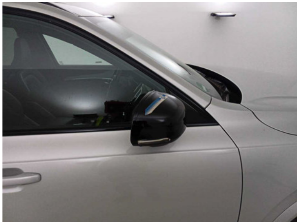
Beschädigung #1: Außenspiegel rechts: Abdeckkappe - Kratzer - Smart Repair
