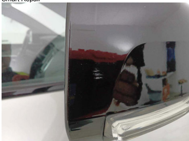
Beschädigung #1: Außenspiegel rechts: Abdeckkappe - Kratzer - Smart Repair
