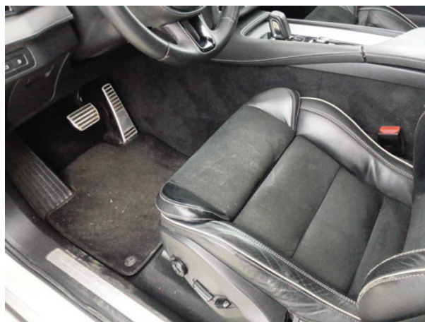
Beschädigung #2: Sitz vorn: Sitzpolster links - Abrieb - aufbereiten
