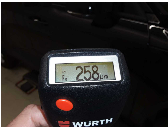
Door - front right side: 258 µm
