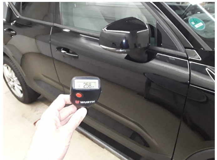
Door - front right side: 258 µm
